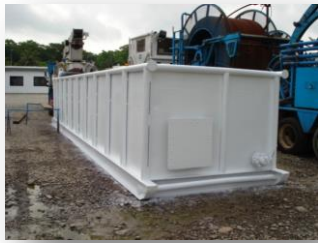
PRESA DE LODOS
